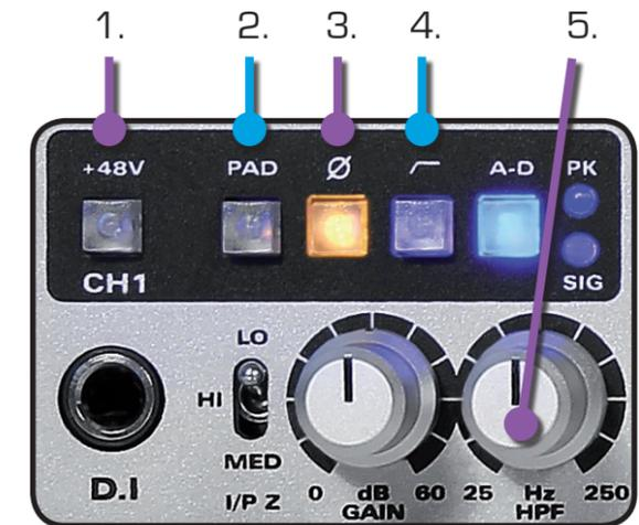
Um die Phasenlage bei Aufnahmen zu überprüfen, arbeiten Sie zunächst an der richtigen Aufstellung der Mikrofone. Drücken Sie dann den Ø Taster (3) in verschiedenen Kanal-Kombinationen und finden Sie dadurch die neutralste klangliche Representation der Klangquelle.
