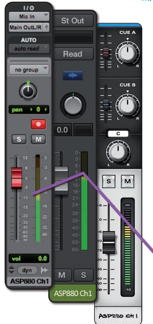
Die LED-Pegelanzeige des ASP880 zeigt einen minimalen Pegel bei -48dBFS (-30dBu) an und steigt bis -28dBFS (-10dBu) an. Die Peak LED warnt bei -2dBFS (+16dBu) vor Übersteuerung. Allerdings sollten Sie auch immer auf die Anzeigen des Aufnahme-Gerätes achten.
